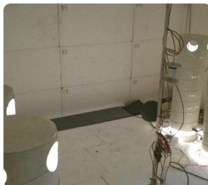
Исследование тепловой и охлаждающей мощности обогревателей с вентилятором VKN5P и конвекторов-кондиционеров CVKP с подачей свежего воздуха было проведено в специально подготовленной климатической камере в соответствии с требованиями европейского стандарта EN-16430 в сотрудничестве с лабораторией HLK Штутгарт в Институте им. ГебаудеЭнергетик Штутгарт.
